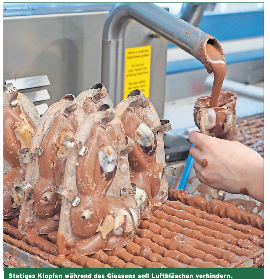
Stetiges Klopfen während des Giessens soll Luftbläschen verhindern.
